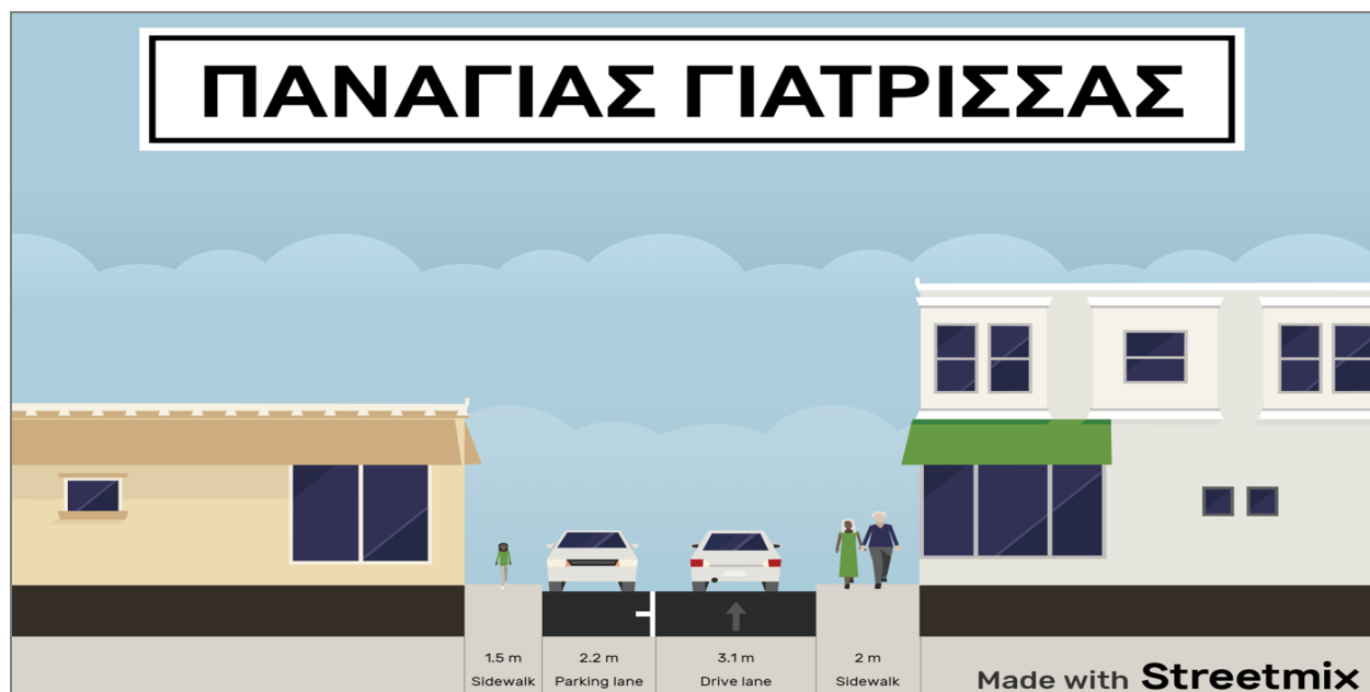
Εικόνα 9: Υφιστάμενη Κατάσταση της οδού Παναγιά Γιάτρισσας (διατομή)
