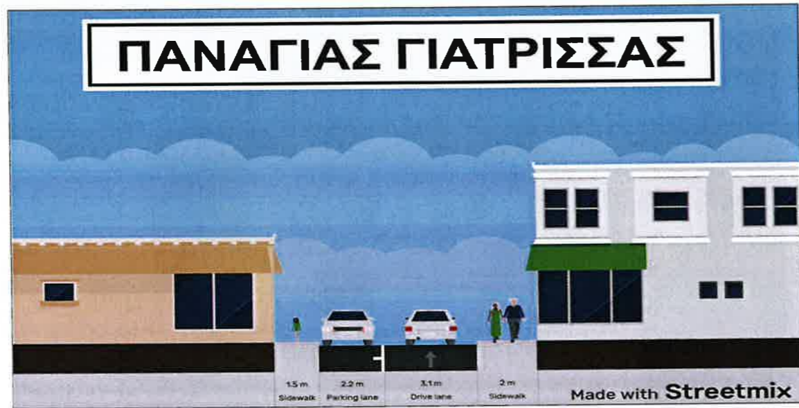
Εικόνα 9: Υφιστάμενη Κατάσταση της οδού Παναγιά Γιάτρισσας (διατομή)
