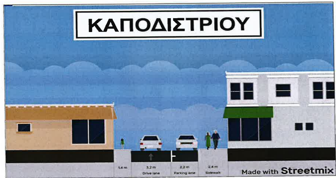
Εικόνα 17: Υφιστάμενη Κατάσταση της οδού Καποδιστρίου (διατομή)
